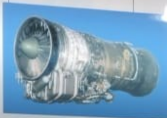
R25-300 TURBO JET FOR MiG 21 BIS AIRCRAFT (1978)
